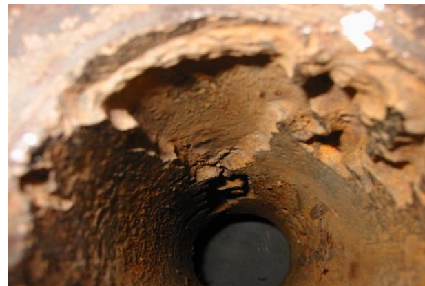
图 6.13 油管接箍外表面的机械损伤
